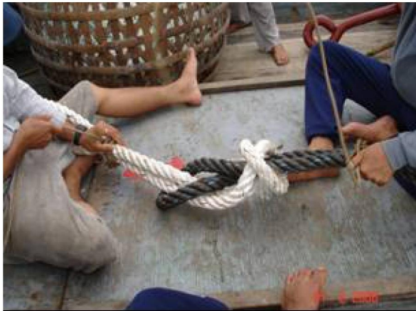
Hình 7.4.3. Nút Nhật nối hai đoạn dây neo
