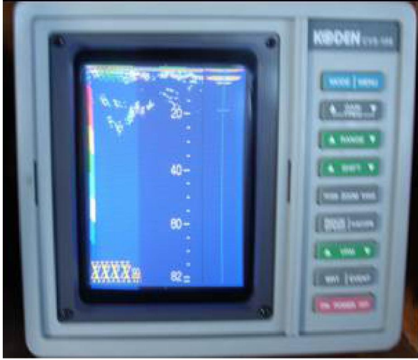
Hình 35. Tín hiệu đàn cá ngữ đại dương nhỏ ở độ sâu 20 – 30m
